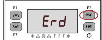
Lorsque le paramètre ERD est activé : La température de consigne de l'eau change en fonction de la température ambiante. La fonction n'est active que si le contrôle de la précision de la température est désactivé (CPT=OFF).
